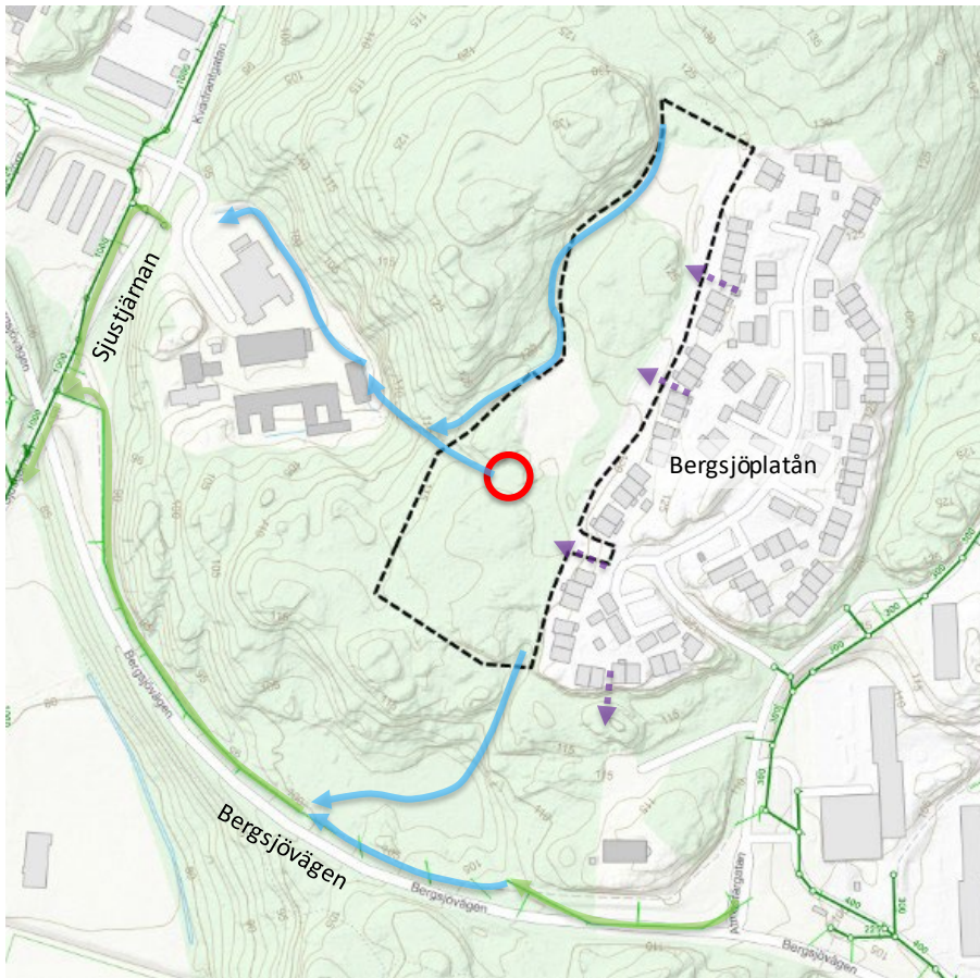
Figur 26 Befintlig dagvattenavledning inom det södra delområdet. Blå pilar visar ytliga avrinningsvägar. Lila pilar visar troligt tillrinning från befintligt bostadsområde. Röd cirkel visar troligt utlopp.
